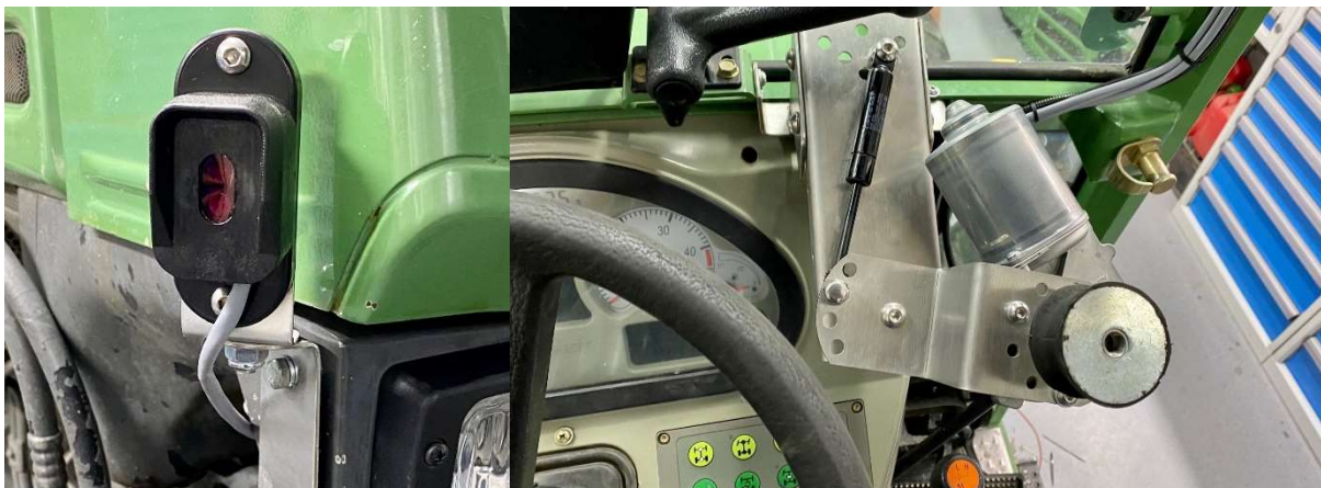
Links: Laserscanner, montiert rechts vorne. Rechts: Lenkradmotor montiert auf einem Fendt.
